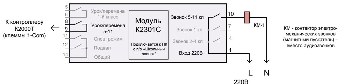
2. K2301CM - электронный модуль управления электрическим школьным звонком и связи с контроллером освещения K2000T через порт LPT персонального компьютера: два звонковых реле и два реле управления освещением коридоров. **Отдельное расписание для 1-х и для 2-11 классов.**
