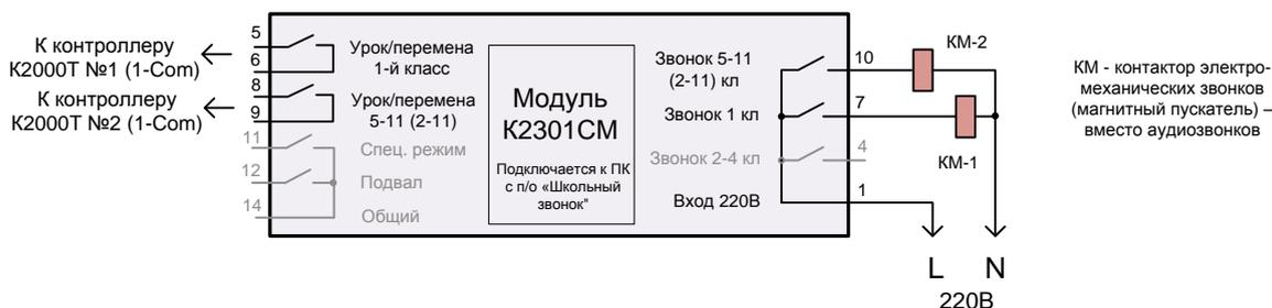
3. K2301CCM - электронный модуль управления электрическим школьным звонком и связи с контроллером освещения K2000T через порт LPT персонального компьютера: три звонковых реле и три реле управления освещением коридоров. **Отдельное расписание для 1-х, 2-4 и 5-11 классов.**
